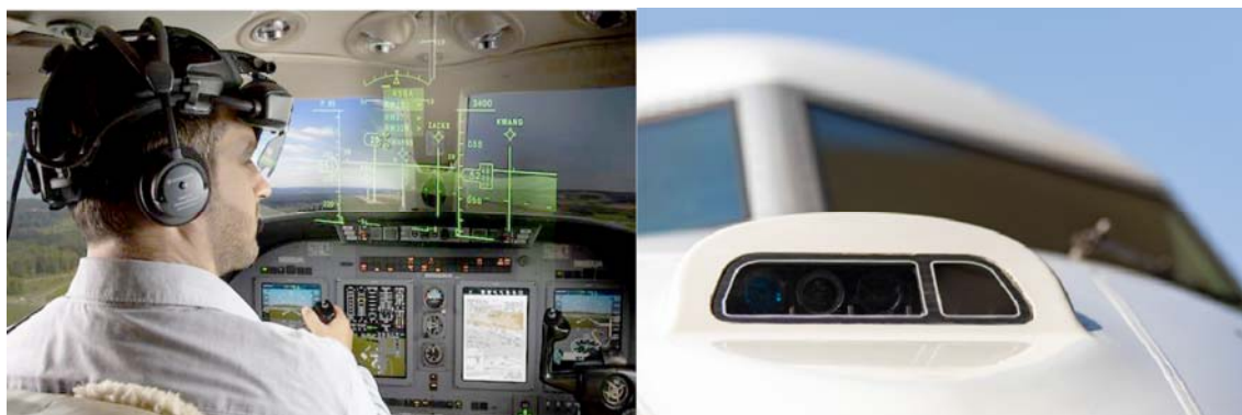
Рис. 9. Система внешнего видения SkyLens ClearVision на основе очков дополненной реальности с функцией управления взглядом
