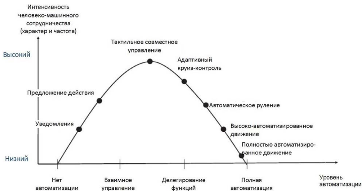
Рис. 3. Зависимость человеко-машинного взаимодействия от уровня автоматизации
