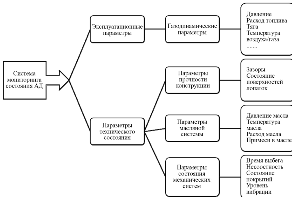
Рис. 2. Параметры контроля авиационного двигателя
