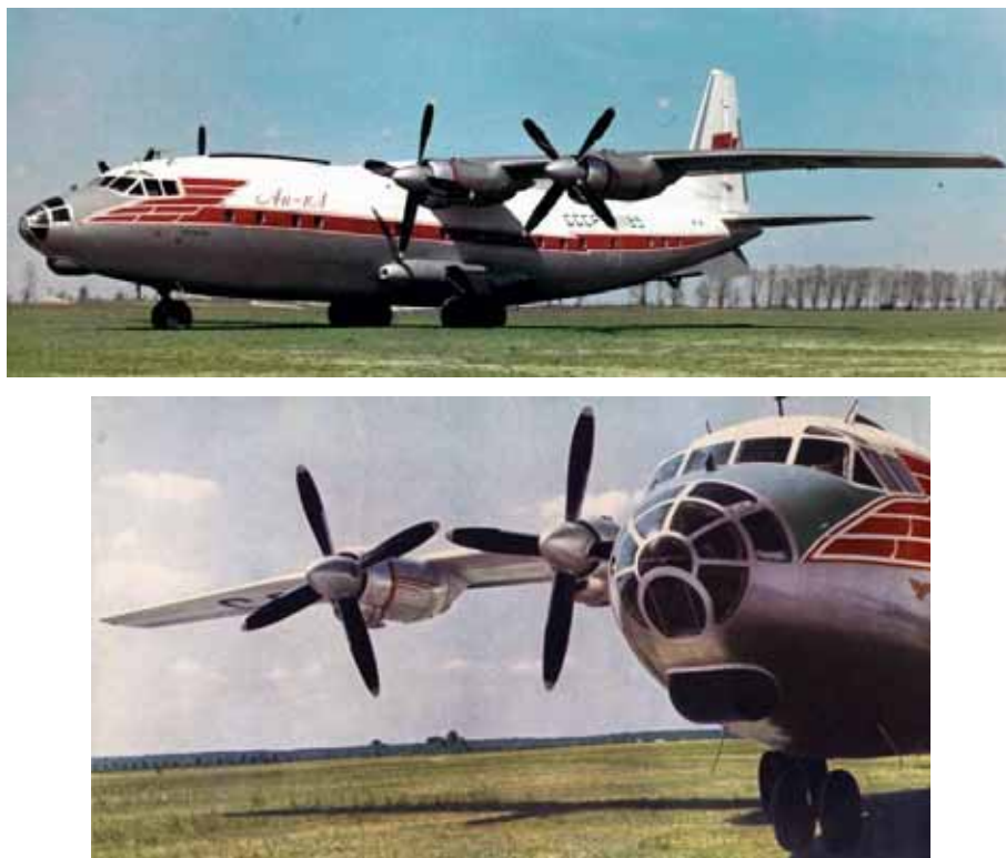
Рис. 4. Самолет Ан-10А «СССР-11185» во время испытаний на возможность работать с грунтового аэродрома
