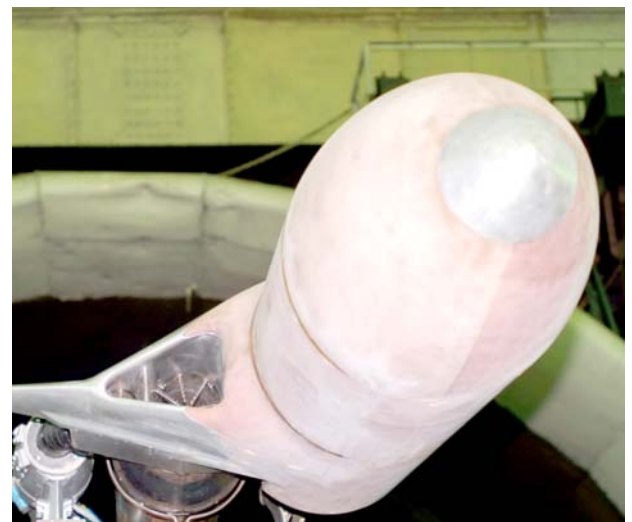
Рис. 6. Модель ВЗУ в аэродинамической трубе ТПД
