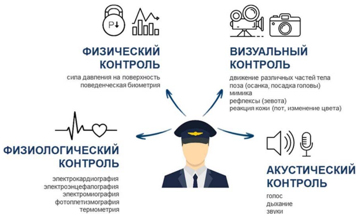
Рис. 8. Методы и средства контроля состояния и действий пилота
